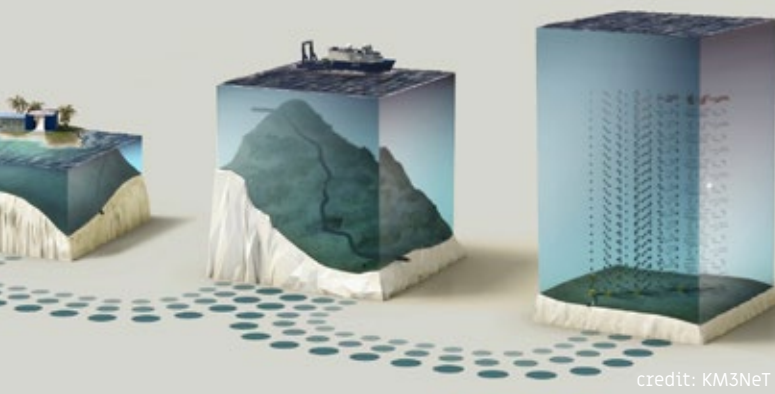
Schema della complessa architettura di cavi sottomarini di Km3Net che permette di inviare i dati raccolti dai sensori installati su torri a 3 km di profondità al centro di calcolo di Portopalo di Capo Passero, in provincia di Siracusa
