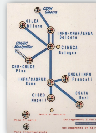
Topologia della dorsale di rete della prima rete GARR che divenne operativa nel 1991
